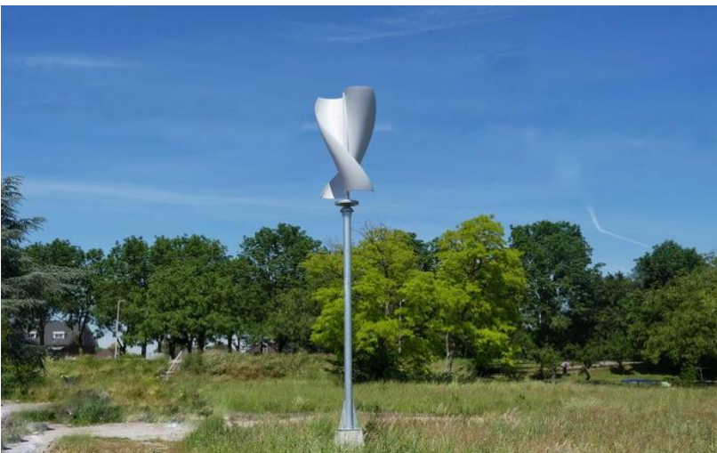
Figuur 2: Een kleine windturbine waarvan de as verticaal is georiënteerd (niet toegestaan in Hollands Kroon).
